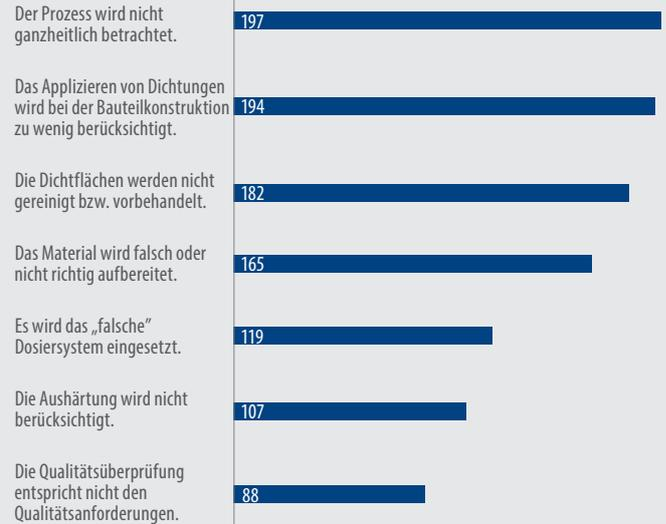
**Bild 23:** Flüssigdichtungen haben sich in vielen Bereichen bewährt, erfordern aber ein umfassendes Know-how. Klappt es nicht, sind die Hauptgründe, dass der Prozess nicht ganzheitlich betrachtet wird und dieser Dichtungstyp bei der Bauteilkonstruktion nicht entsprechend beachtet wurde. (Bild: ISGATEC GmbH)
