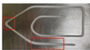
Bild 2: Aufgetragene Klebraupe: Links ist die aufgetragene Raupe auf einer Musterplatte zu sehen. Rechts ist das digital gescannte Klebstoffraupenvolumen zu sehen, das vom Lasersensor bewertet wurde, mit roten Markierungen für Bereiche, die nicht den Spezifikationen entsprechen (Bild: Coherix)
