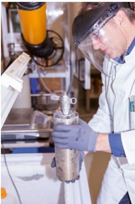
Bild 3: Die Arbeit mit Sondermedien erfordert besondere Sicherheitsvorkehrungen, wie Absaugung, Gesichtsschutz und Schutzhandschuhe (Bild: Tobias Ehmer)
