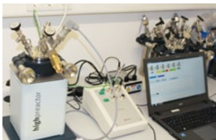
Bild 2: Arbeitsplatz mit CO 2 -Hochdruckautoklav mit Druck- und Temperaturfühlern zur kontinuierlichen Aufzeichnung dieser Parameter. Der Autoklav befindet sich in einem geregelten Heizblock (Bild: O-Ring Prüflabor Richter)
