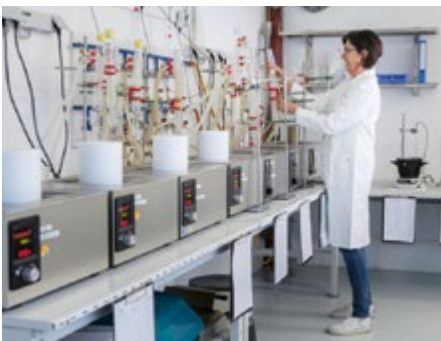
Bild 1: Prüfraum zur Durchführung von Beständigkeits-tests in Sondermedien – vorne links: Autoklav im Ölbad, hinten links: Glaskolben mit Rückflusskühler, hinten rechts befindet sich ein Magnetrührwerk (Bild: Tobias Ehmer)
