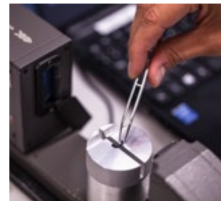
Bild 2: Laser-Scan-Mikrometer (LSM) bei der Höhenmessung eines O-Ring-Abschnittes (Bild: Tobias Ehmer)
