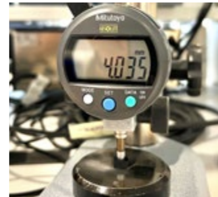
Bild 1: Höhenmessung mit einer digitalen Messuhr im Rahmen einer Druckverformungsrestprüfung (Bild: OPR Group GmbH)
