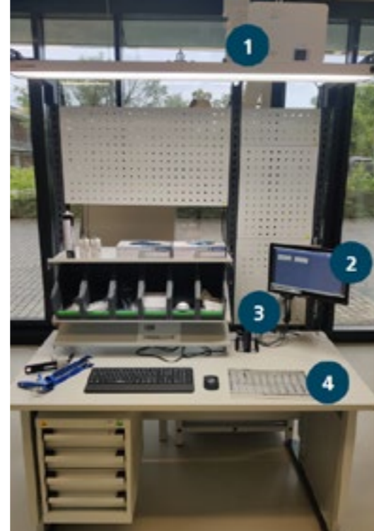
Bild 1: Technologie-Demonstrator (1: Beamer und Kamerasystem, 2: Display für HMI, 3: Scanner und weitere Messsysteme, 4: Arbeitsbereich mit Bauteil) (Bild: Fraunhofer IPA)
