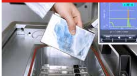
Vortest von unbefüllten, prismatischen Batteriezellen in der Vakuumprüfkammer (Bild: INFICON GmbH)
