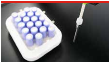
2K-Dispenser ViscoDuo-P 4/4 beim Verguss eines Batteriemoduls (Bild: ViscoTec Pumpen u. Dosiertechnik GmbH)
