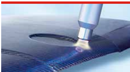
Prozesssicherheit im Leichtbau: Plasma-Vorbehandlung einer CFK Motorhaube vor dem Verkleben (Bild: Plasmatrete GmbH)
